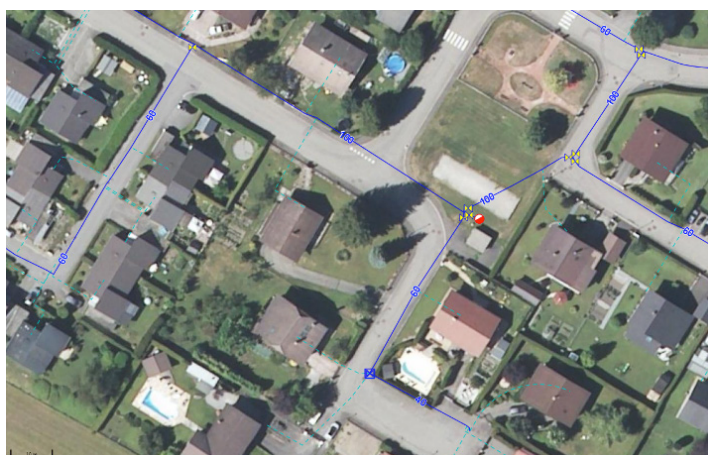
Géoréférencement des réseaux d'éclairage public (Savoie)
